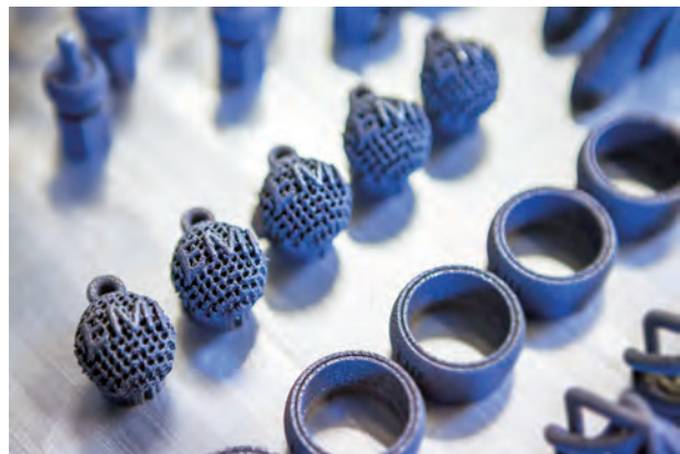
13 Demonstrationsobjekte möglicher geometrischer Komplexität auf der Bauplattform.
