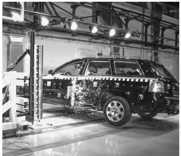
8 Durch die Aufzeichnung des Crashvorgangs mit Hochgeschwindigkeitskameras aus verschiedenen Perspektiven lassen sich Video- und Messsignale synchronisiert auswerten.
