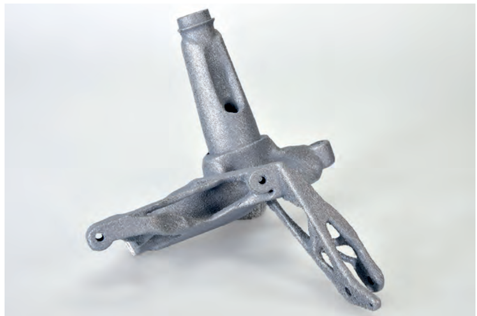
17 Anordnung mehrerer Strukturkomponenten auf einer Grundplatte nach abgeschlossenem Lasersinterprozess (oben), im Lasersinterprozess hergestellte Leichtbaukomponente »Radträger« mit komplexer Strukturgebung (unten).
