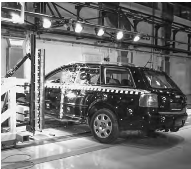
8 Durch die Aufzeichnung des Crashvorgangs mit Hochgeschwindigkeitskameras aus verschiedenen Perspektiven lassen sich Video- und Messsignale synchronisiert auswerten.
