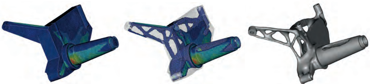
16 Finite-Elemente-Analyse des Startdesigns eines Technologiedemonstrators »Radträger« (links), numerische Designoptimierung des Technologiedemonstrators zur Reduktion der Masse ohne funktionelle Beeinträchtigung der Komponente (Mitte) und CAD-Vorlage zur Fertigung des 3D-Metallbauteils (rechts).
