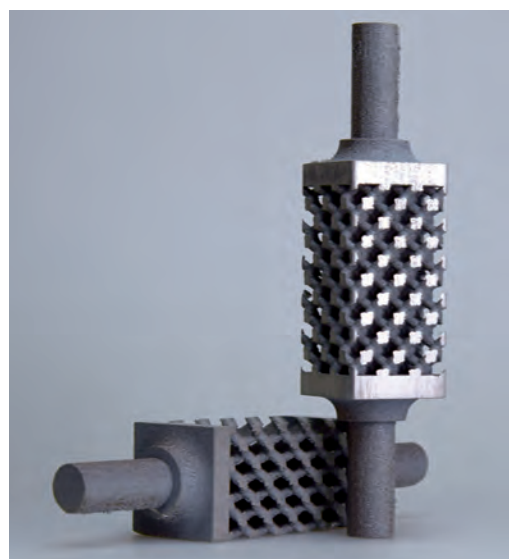
14 Im 3D-Druckverfahren gefertigte strukturierte Zugversuchsproben.
