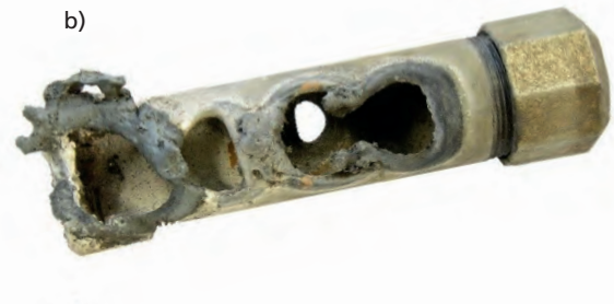
4 Rohrbombe vor (a) und nach (b) Entschärfung durch einen Hochleistungslaser mit vollständigem Abbrand des Explosivstoffs.
