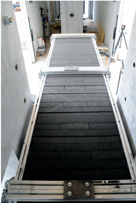
14 Soft-Catch-Box zum weichen Auffang von Projektilen, gefüllt mit Glasschaumplatten.
