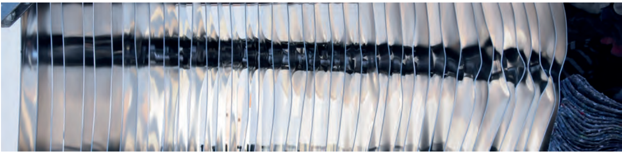
12 Aufbau aus Aluminiumblechen zum kontrollierten Projektilauffang, Seitenansicht nach dem Versuch.
