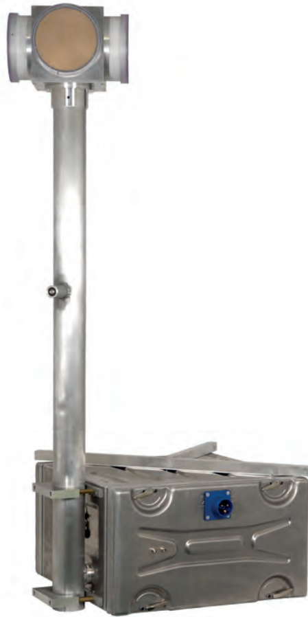
9 Prototyp eines Sensor-knotens zur Messung von Detonationen und Hochleistungsmikrowellen in der Implementierung. Am Ende des Mastes sind die Antennen positioniert, die Drucksensoren mittig und auf dem Behälter, der die Elektronik und Betriebskomponenten enthält.
