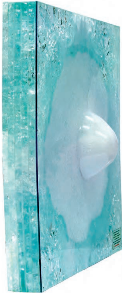
1 Massive Schädigung und Verformung eines Glas-Polycarbonat-Laminats nach Beschuss mit splitterdarstellendem Geschoss.
