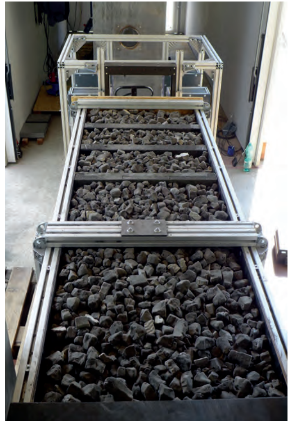
15 Soft-Catch-Box, gefüllt mit Glasschaumschotter.
