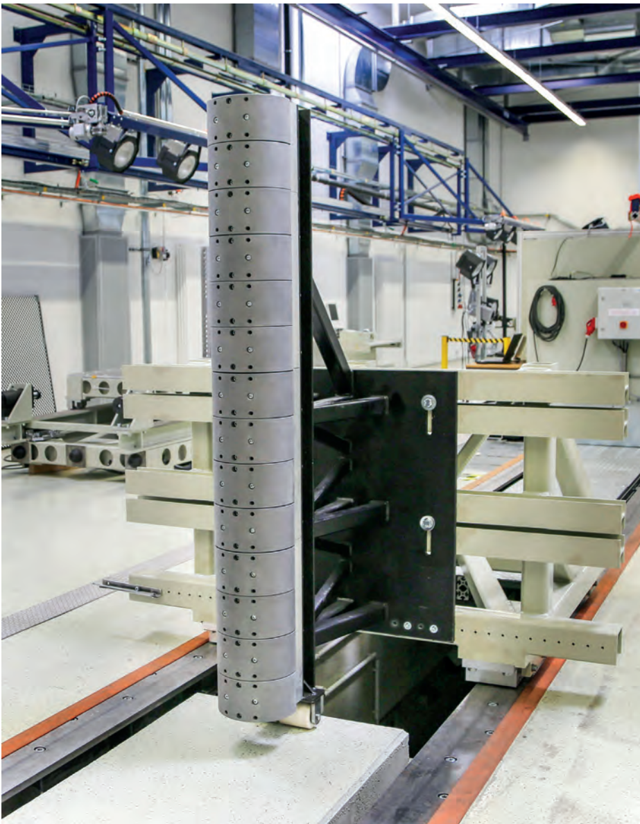
7 Der instrumentierte Crashpfahl besitzt 14 Kraftsensoren, welche die während des Crashvorgangs lokal wirkenden Kräfte in drei Raumrichtungen aufzeichnen.
